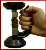
Адаптеры на сжатие для испытания лифтовых дверей и пр. | 6000       |
