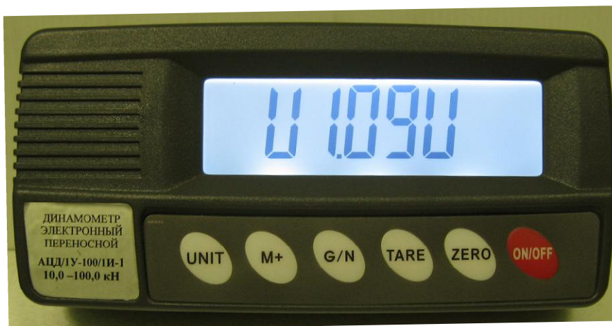
Рисунок 1. Внешний вид электронного блока с изображением версии программного обеспечения.
