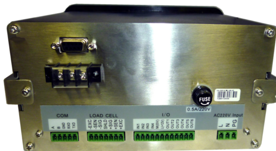
Рис. 3 «Электронный блок тип АЦД/2. Вид сзади»
